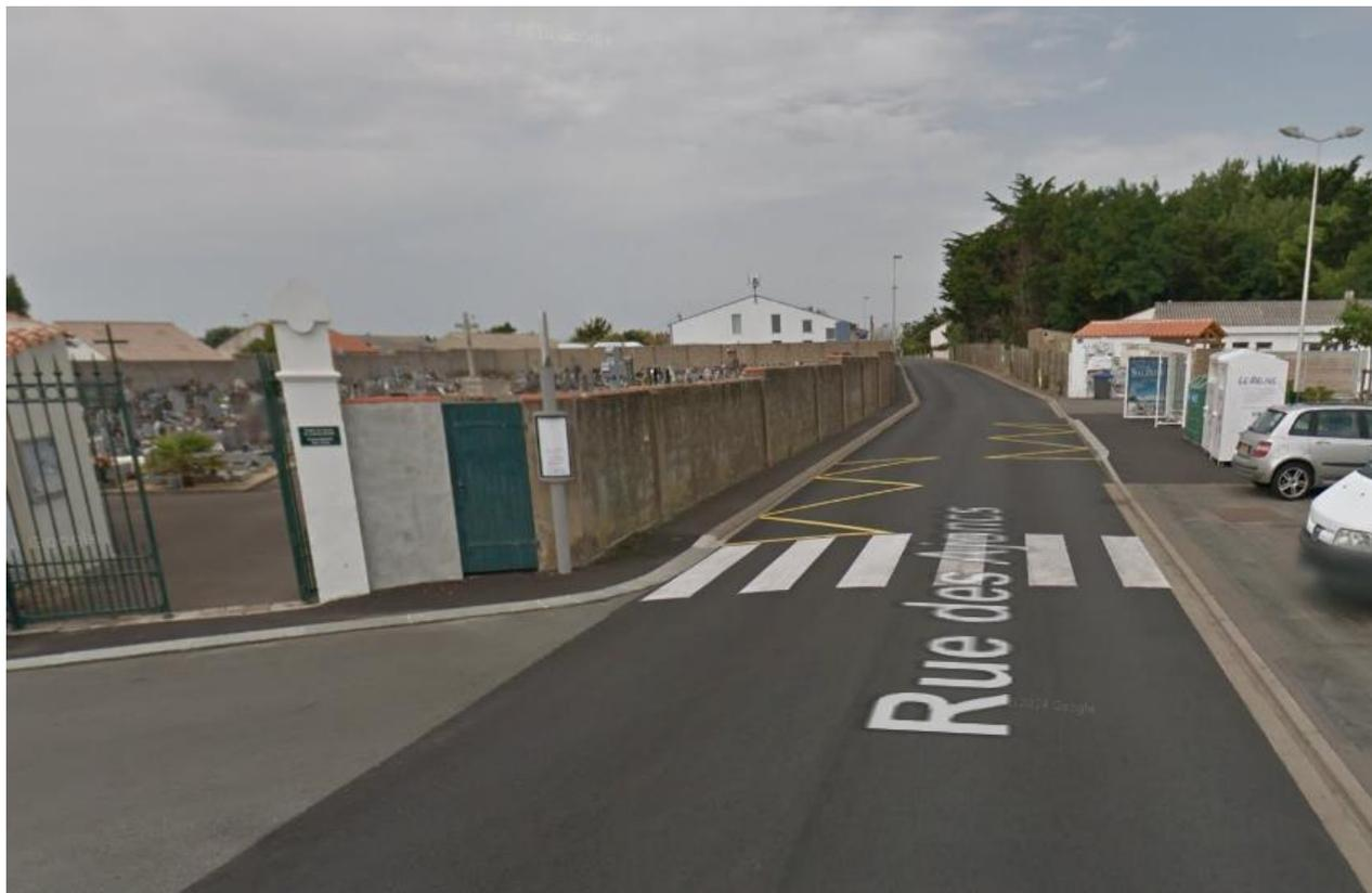
La faible largeur du trottoir, inférieure à 1 m ne permet pas de rendre accessible cet arrêt. Par ailleurs, la chaussée d'une largeur de 5 m est trop réduite pour autoriser un élargissement du trottoir et répondre aux largeurs recommandées.
