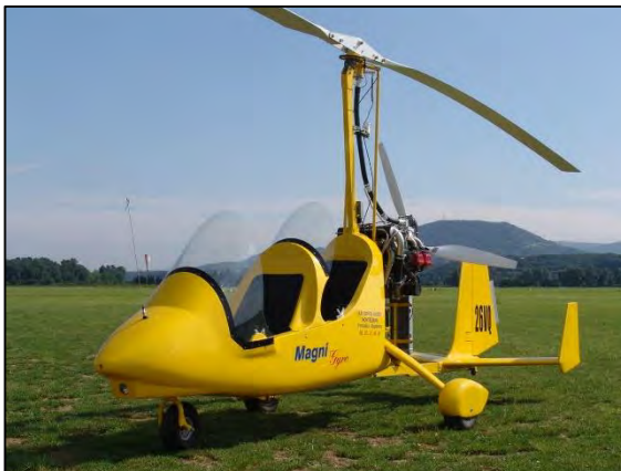
Activité d'ULM Aéronef propulsé par une hélice à moteur, à voilure tournante libre assurant la sustentation
